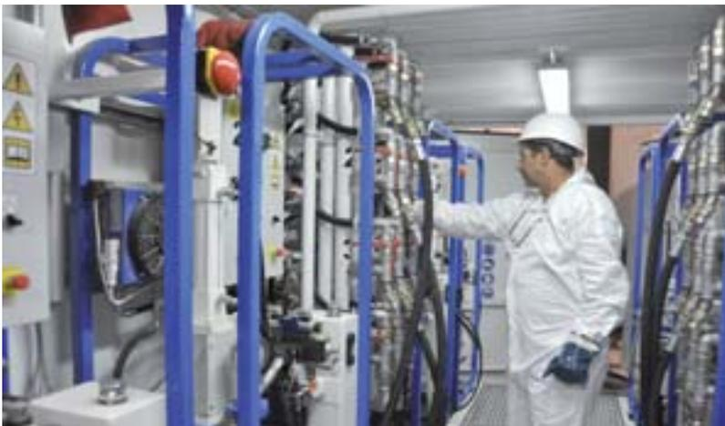
Impianto di iniezione SOILMEC SGJ-8
